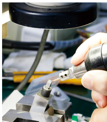
最後は顕微鏡で確認しながら手作業による研磨加工で精度を追い込んでいく
