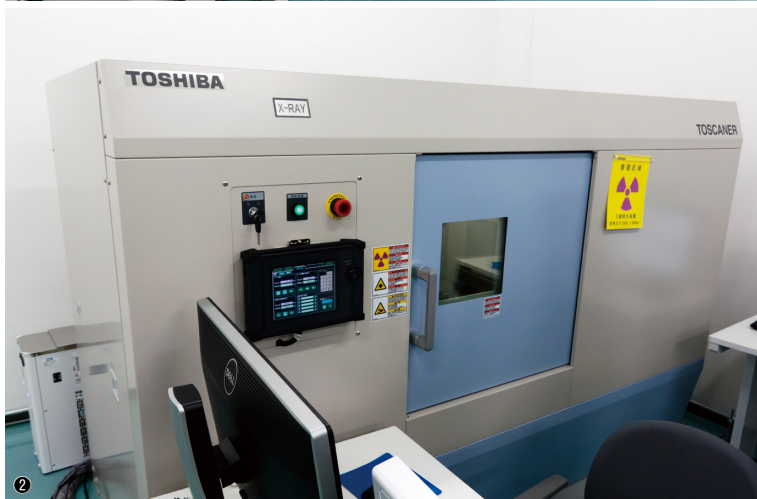
①(株)ナカヤマ精密のテクニカルセンターの検査室。X線CTをはじめ、様々な精密測定機器が設置されている／②産業用X線CT／③ベースノズルの加工サンプル。先端に \phi 20\mu の孔があいている／④産業用X線CTによる非破壊検査
