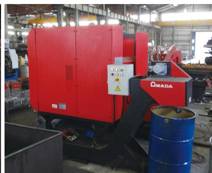
DYNASAW-430に本体から排出された切屑をドラム缶の高さまで運ぶ別置き型のチップコンベアを設置、人手がかからない運用を実践している
