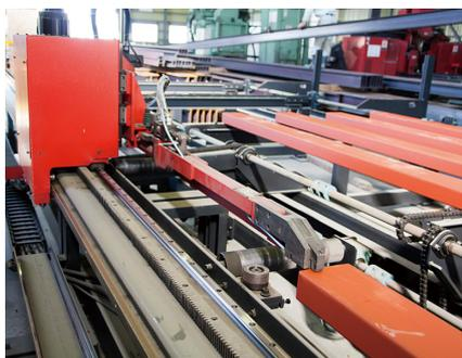
3BC-300にはオプションの平面ローディング装置（長さ5m）を装着し、材料の自動搬入に対応
