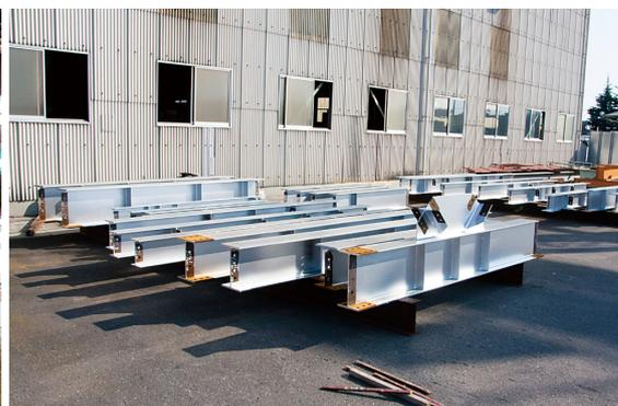
一次加工の後、様々なサイズの鉄骨を組み合わせて仕口などをつくる(左) / 指定色に塗装した大手プラントメーカー向けプラント鉄骨(右)
