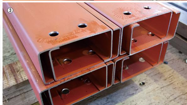
①2012年11月に導入した小型形鋼穴あけ切断複合機「3BC-300」(平面ローディング装置、インクジェット装置付き) / ②3BC-300によるC型チャンネルの穴あけ加工 / ③穴あけ・切断加工後のC型チャンネル
