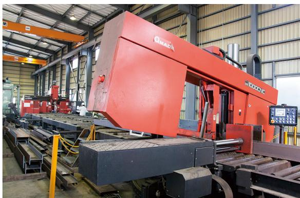
従来からあるCNC形鋼切断用バンドソー「HK-1000CNC」（手前）とH鋼・NC6軸高速穴あけ加工機「6BH-1000」（奥）のライン。3BC-300の導入で2ライン体制となり、生産性が大幅に向上した
