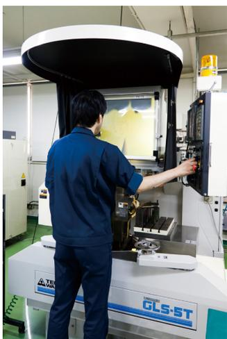
プロファイル研削盤GLS-5T。コネクタやリードフレームのパンチ・ダイなど、微細部品の研削加工を行う
