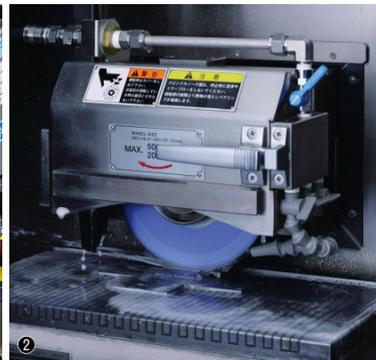
① 高精度成形研削盤 MEISTER / ② MEISTERによる研削加工(アマダマシンツール提供) / ③ 高精度成形・平面研削盤 TECHSTER、高精度成形研削盤MEISTERで製作した金型部品。工具鋼や超硬合金・セラミックス・PCDなど高硬度材料の研削加工を行う
