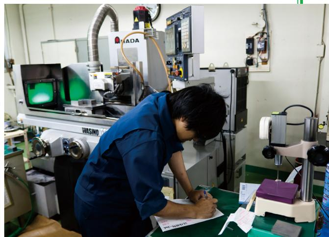
高精密成形研削盤MEISTER(左)で加工後、精度計測を行う(右)
