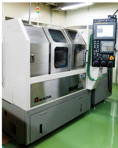
2009年にいち早く導入したグラフィカルプロファイル研削盤DV-1の初代モデル
