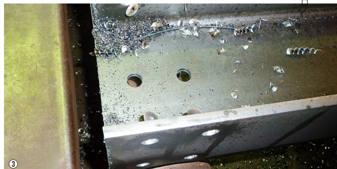
① 2013年9月に導入したCNC3軸全自動H形鋼ドリルマシン3DH-1000Ⅲ。「老朽化が進んだ前の設備(3BH-900)と比べ、生産性は2倍以上に改善しました」(下田社長) / ② 3DH-1000ⅢによるH鋼の穴あけ加工 / ③ ウェブとフランジに穴あけ加工を行った後のH鋼
