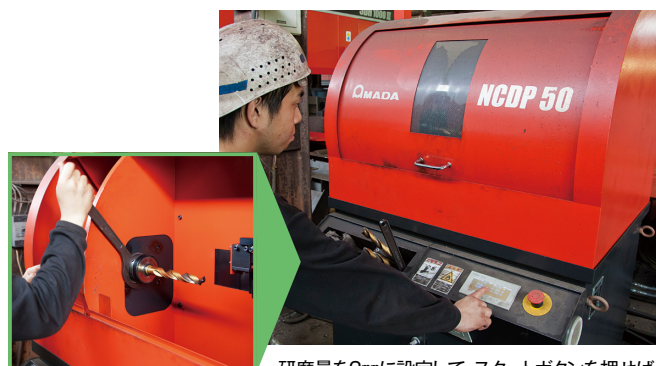
NC鉄骨ドリル研削盤NCDP-50にドリルをセット
